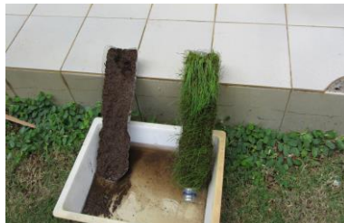
Fig.5 – Quantidade de solo erodido em função da vegetação existente na garrafa.
